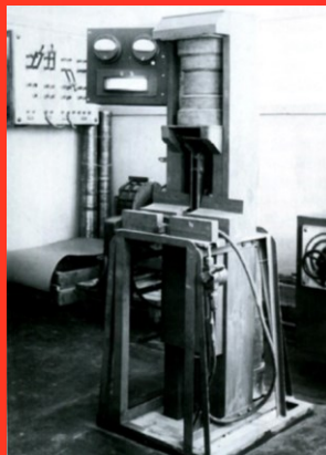
Аппарат для контроля корпусов артиллерийских снарядов, 1943 г.
